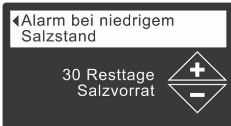
Abb. 11: Alarm bei niedrigem Salzstand einstellen
